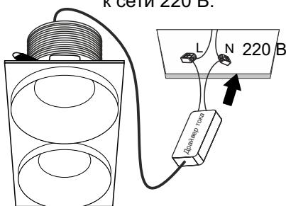
**!** Установка светильника осуществляется при выключеной электрической сети.
